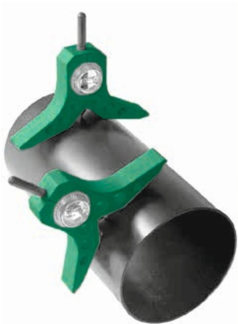
С градусной шкалой и пузырьковым уровнем для разметки средней линии и отводов на трубах и баках под любым углом. Определение угла наклона, выставление углов, поиск средней линии на трубах, нивелирование при установке баков и др. Уровень с градусной шкалой может вращаться, что позволяет легко без пересчета определять и устанавливать угол и наклон. Материал: анодированный алюминий. Кернер: закалённая инструментальная сталь.
