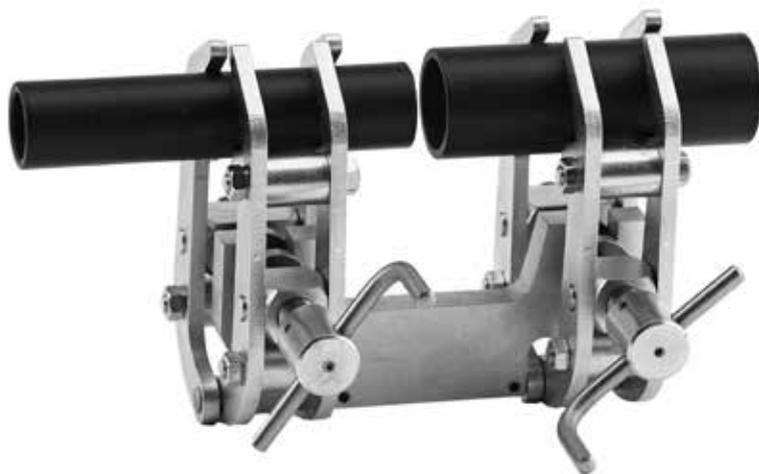
Быстрое, надежное, точное центрирование и зажим труб, валов и круглых стержней - в том числе при большой разнице диаметров, благодаря автоматической коррекции положения соединяемых элементов. Без дополнительного выравнивания, без помощников, без промежуточного контроля. Места сварки всегда доступны со всех сторон.
