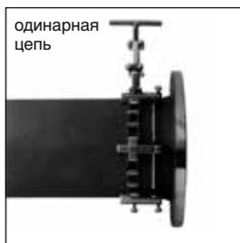
Для точного центрирования и зажима длинных труб неограниченной длины, а также трубных колен, тройников, фланцев, переходников, другой трубной арматуры и резервуаров. Гибкие наружные центрирующие цепи CENTROMAT® подходят для любых труб и резервуаров. Их можно удлинять или укорачивать на любую длину, просто вставляя или удаляя дополнительные звенья. Имеются 5 исполнений, а также за дополнительную цену исполнения из гальванизированной или нержавеющей стали.
